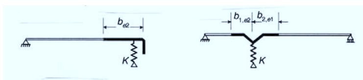
Figura C4.2.31 – Schematizzazione degli irrigidimenti
